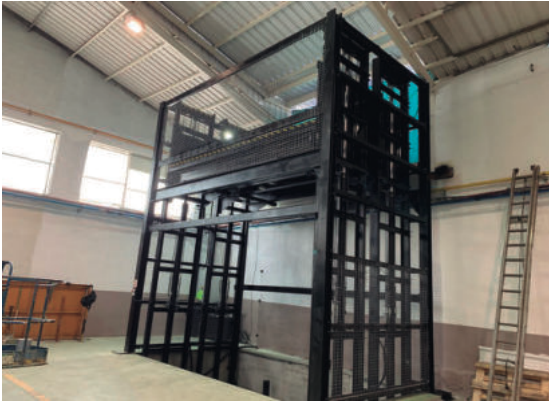
Montacargas (5.000mm x 3.000mm - Elevación 5 m - Capacidad de 14.000kgs)
